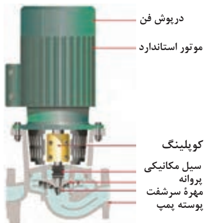
شکل ۱۴- اجزای داخلی یک سیرکولاتور خطی گلدلس (روتور خیس) بدون کوپلینگ شکل ۱۵- اجزای داخلی یک سیرکولاتور خطی گلدلس با کوپلینگ صلب
