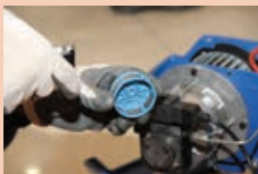
بازکردن درپوش پمپ و تمیز کردن فیلتر
