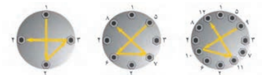
شکل ۲۳- ترتیب سفت کردن پیچ‌های فلنج
