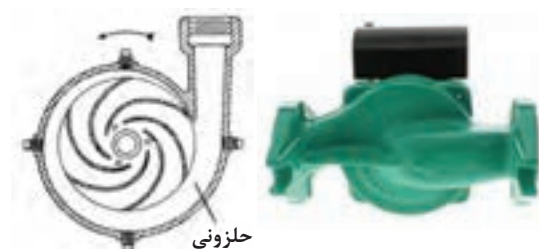
شکل ۷- پوسته حلزونی در پمپ خطی و زمینی
